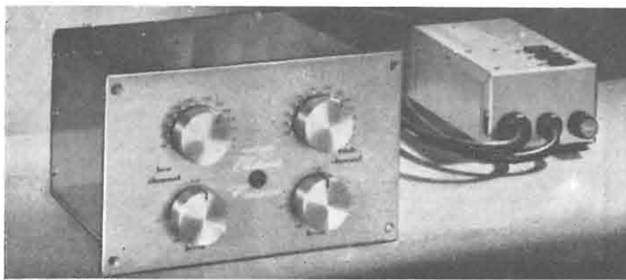
Fig. 5 bis « Crossover » elettronico Marantz. Si vede anche l'alimentatore staccato.
